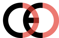
Marcatura CE contraffatta (troppo vicino)
